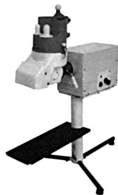
Рис. 1.2. Универсальная кухонная машина (УКМ-01)
